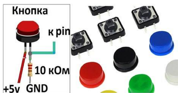
Рис. 1. Схема подключения тактовой кнопки к микроконтроллерной плате
