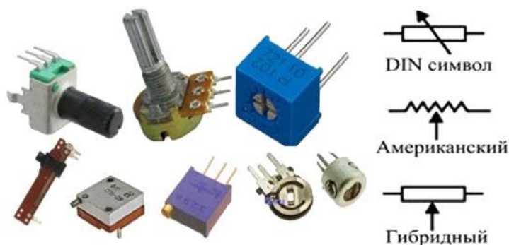
Рис. 10. Переменные резисторы (потенциометры)
